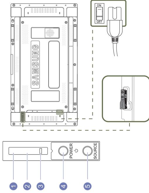
— Zestaw czujników zewnętrznych składa się z czujnika zdalnego sterowania, czujnika jasności oraz klawiszy funkcji. W przypadku montowania wyświetlacza na ścianie można przesunąć zestaw czujników zewnętrznych na boczną część wyświetlacza.
