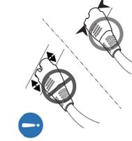
W przypadku podłączania wtyczki do portu upewnić się, że została ona podłączona prawidłowo (całkowicie).
