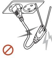
Po podłączeniu do gniazda elektrycznego wtyczki przewodu zasilającego nie można wkładać żadnych podłużnych przedmiotów ani innych przedmiotów przewodzących prąd elektryczny do wtyczki na jego drugim końcu. Po odłączeniu wtyczki przewodu zasilającego od gniazda zasilającego przez chwilę nie wolno dotykać jej styków.
