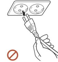
Odtaczając przewód zasilający od gniazda elektrycznego, trzymać za wtyczkę.
