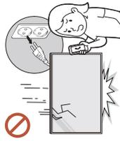
W przypadku upuszczenia produktu lub zmiany jego wyglądu przestawić wyłącznik zasilania do pozycji wyłączenia i odłączyć przewód zasilający. Następnie skontaktować się z Centrum Obsługi Klienta firmy Samsung.
