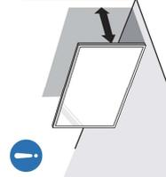
Produktu nie należy stawiać bezpośrednio przy ścianie — należy zapewnić swobodny przepływ powietrza.
