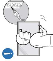
Przed przeniesieniem produktu wyłączyć przetątnik zasilania i odłączyć przewód zasilający oraz wszystkie inne podłączone kable. Uszkodzenie przewodu może spowodować pożar lub porażenie prądem elektrycznym.
