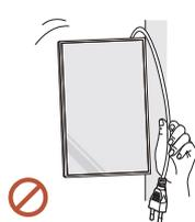
Nie przesuwać produktu, ciągnąć za przewód zasilający albo inny kabel.
